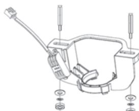
Τοποθετήστε τη βάση στήριξης σε κατάλληλο σημείο στην οροφή (λάβετε υπόψιν τις οδηγίες ασφαλείας) και τοποθετήστε σημάδια για τις τρύπες που πρέπει να ανοίξουν. Αφαιρέστε το στήριγμα και τρυπήστε την οροφή από σκυρόδεμα κάνοντας 2 τρύπες που αντιστοιχούν στη διάμετρο των συμπεριλαμβανόμενων ούπα. Στη συνέχεια εισάγετε τα ούπα στις τρύπες και πιέστε τα μέσα χρησιμοποιώντας ένα σφυρί. Τοποθετήστε το στήριγμα στην κατάλληλη θέση και ασφαλίστε καλά με τις παρεχόμενες βίδες, ροδέλες και παξιμάδια.
