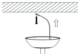
6. Τοποθετήστε τον δέκτη του τηλεχειριστηρίου ανάμεσα στη βάση στήριξης και τον σφαιρικό σύνδεσμο όπως φαίνεται παρακάτω:
