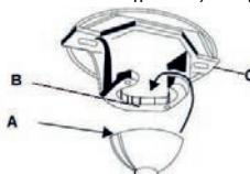
5. Για μεγαλύτερη ασφάλεια, στερεώστε το παρεχόμενο καλώδιο ασφαλείας, ιδανικά σε ένα σημείο ανεξάρτητο από το σημείο στερέωσης, ή για παράδειγμα σε μία βίδα με άγκιστρο σε οροφή από σκυρόδεμα.
