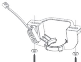
**ΣΗΜΕΙΩΣΗ:** Οι βίδες στερέωσης που περιλαμβάνονται στη συσκευασία προορίζονται για χρήση σε ξύλινες κατασκευές. Για κατασκευές από άλλο υλικό, π.χ. τσιμεντένιες κατασκευές, θα πρέπει να χρησιμοποιηθεί ο κατάλληλος τύπος βίδας.
